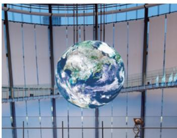
高輝度・高解像度で、宇宙空間に輝く地球の姿をリアルに映し出す日本科学未来館のシンボル展示です。1万362枚のLEDパネルを使用しています。毎日、人工衛星が撮影した画像を取り込んで、雲の映像を流している「地球ディスプレイ」です。
