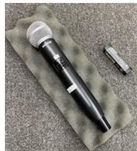
ワイヤレスマイク Shure/GLXD2/SM58 × 2本 リチウムイオン充電電池 SB902 × 4本
