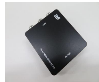
RCA→HDMIコンバーター×1台 (RCA端子変換機) ラトックシステム/RS-AV2HD1
