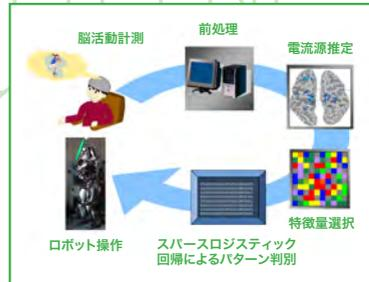
BMIのしくみの概念図。脳と情報通信機器をつなぎ、脳の指令をデジタル信号に置き換え、機械を制御する
