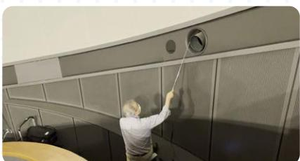
ドーム内部の空気の出入りを計測します。データは、シミュレーションの条件を決めたり、結果を補正したりするのに使われます。
