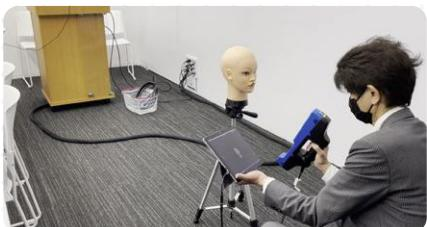
ドーム内部の飛沫の動きをシミュレーション前に実測するために、人工唾液を飛ばすマネキンを用いました。
