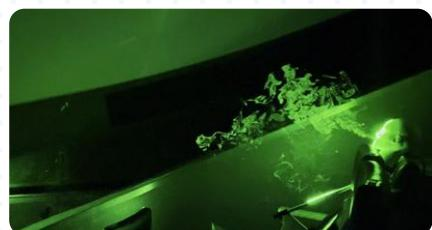
飛沫を飛ばすマネキンを座席に座らせて、空間の飛沫量を測定します。レーザーを当てることで、飛沫が見えやすくなります。
