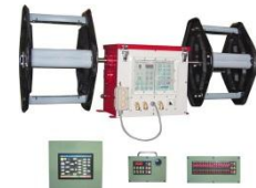
はまで式全自動イカ釣り機：世界発のコンピュータ制御式。一本釣り形式だったイカ釣り漁に革命を起こした。
